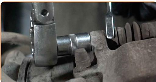
**11** Entfernen Sie die Befestigungsschrauben.
