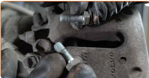
**12** Entfernen Sie den Bremssattel.
