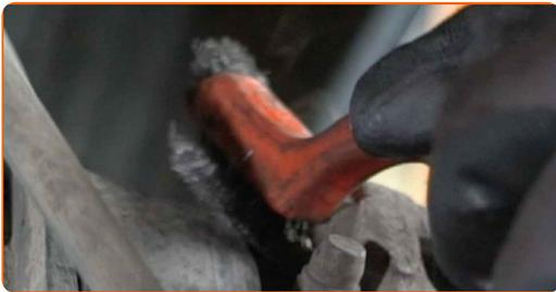
**10** Schrauben Sie die Befestigungen des Bremssattels ab. Verwenden Sie Ring-Gabelschlüssel Nr. 15. Verwenden Sie Stecknuss Nr. 13. Verwenden Sie einen Ratschenschlüssel.
