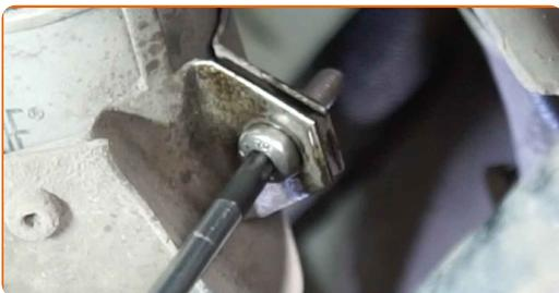
**7** Reinigen Sie die Befestigungen der Kraftstoff-Zuleitungen. Verwenden Sie Allzweckreinigungsspray.
