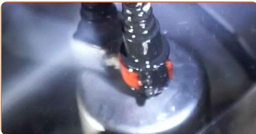
**8** Lösen Sie die Kraftstoffzulaufleitungen vom Kraftstofffilter. Verwenden Sie einen flachen Schraubendreher.
