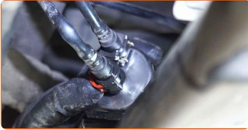
**13** Schrauben Sie den Befestigungssitz des Kraftstofffilters ein. Verwenden Sie den Torx T30. Verwenden Sie einen Ratschenschlüssel.
