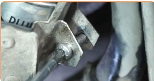
**14** Den Flüssigkeitsbehälter unter dem Kraftstofffilter entfernen.
