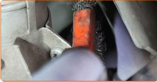
**6** Lockern Sie die Befestigungen des Kraftstofffilters. Verwenden Sie den Torx T30. Verwenden Sie einen Ratschenschlüssel.
