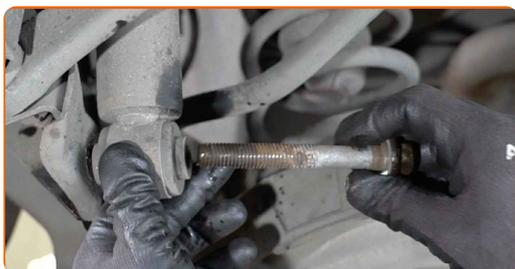
**13** Entfernen Sie den Stoßdämpfer.
