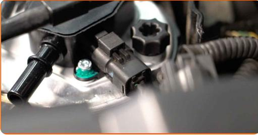
13 Verbinden Sie die Kraftstoffversorgungsleitungen zum Kraftstofffilter.
