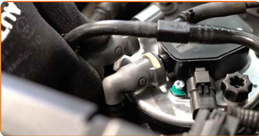
14 Schrauben Sie die Befestigungsbolzen der Treibstofffilterhalterung an. Verwenden Sie Stecknuss Nr. 8. Verwenden Sie Stecknuss Nr. 10. Verwenden Sie einen Ratschenschlüssel.
