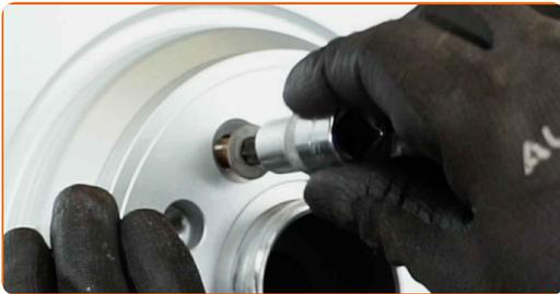
**26** Schrauben Sie die Befestigungen der Bremsscheibe fest. Verwenden Sie den Torx T50. Verwenden Sie einen Drehmomentschlüssel. Ziehen Sie ihn mit 15 Nm Drehmoment fest.
