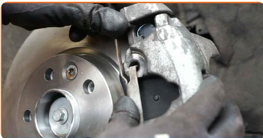
**23** Behandeln Sie die Oberfläche, an der die Bremsscheibe die Felge berührt. Verwenden Sie Keramikfett.
