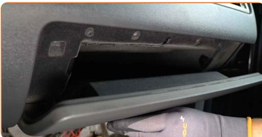
**8** Schrauben Sie die Befestigungsschrauben des Handschuhfachs ab. Verwenden Sie den Torx T25. Verwenden Sie Stecknuss Nr. 8. Verwenden Sie einen Ratschenschlüssel.
