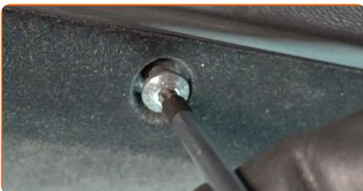
9 Entfernen Sie die Seitenverkleidung auf der Beifahrerseite.
