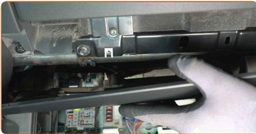
**6** Entfernen Sie den Sicherungskasten und legen Sie ihn beiseite.
