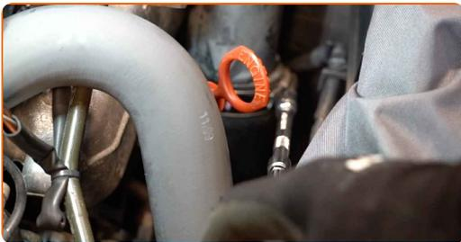
**26** Schrauben Sie das Befestigungselement des Luftansaugrohrs ein. Verwenden Sie Stecknuss Nr. 10. Verwenden Sie einen Ratschenschlüssel.
