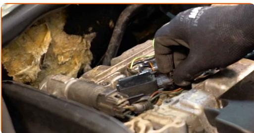
**23** Entfernen Sie das Mikrofaser Tuch vom Luftansaugschlauch.
