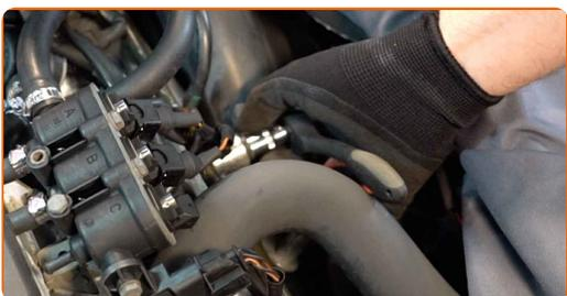
**7** Lösen Sie die Luftansaugschlauchklemme. Verwenden Sie Stecknuss Nr. 7. Verwenden Sie einen Ratschenschlüssel.
