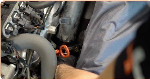
**25** Ziehen Sie die Klemme am Luftansaugschlauch fest. Verwenden Sie Stecknuss Nr. 7. Verwenden Sie einen Ratschenschlüssel.
