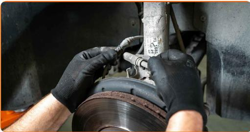
21 Reinigen Sie die Befestigungselemente, welche den Stabilenker mit dem Federbein verbinden, sowie die, welche das Federbein mit dem Achsschenkel verbinden. Benutzen Sie eine Drahtbürste. Benutzen Sie WD-40-Spray.
