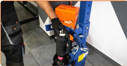
41 Installieren Sie die Feder am Stoßdämpfer.
