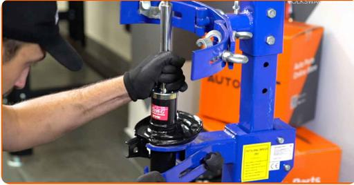
40 Installieren Sie die Staubschutzmanschette und den Anschlagpuffer auf dem neuen Stoßdämpfer.
