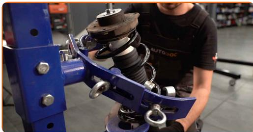
**47** Installieren Sie das Federbein am Radlauf.
