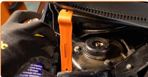
**6** Lösen Sie die obere Befestigung des Domlagers. Verwenden Sie Stecknuss Nr. 13. Verwenden Sie einen Ratschenschlüssel.
