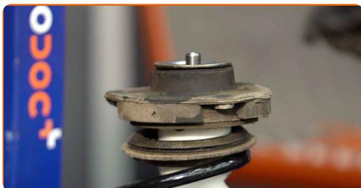
**44** Ziehen Sie die Federbeinkolbenstangenmutter an. Verwenden Sie Inbusschlüssel Nr. H6. Verwenden Sie Stecknuss Nr. 21. Verwenden Sie einen Drehmomentschlüssel. Ziehen Sie ihn mit 60 Nm Drehmoment fest.
