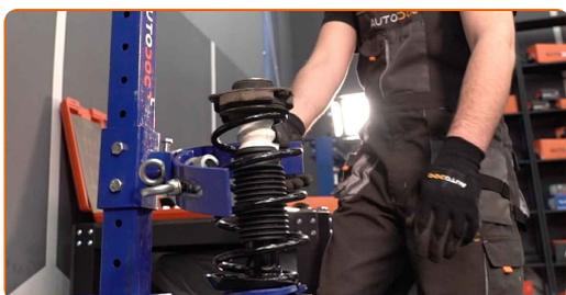
**46** Entfernen Sie das zusammengebaute Federbein.
