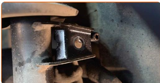
**18** Schrauben Sie das untere Befestigungselement ab, das das Federbein mit dem Achsschenkel verbindet. Verwenden Sie Stecknuss Nr. 18. Benutzen Sie den XZN #12. Verwenden Sie einen Ratschenschlüssel. Verwenden Sie ein Windeisen.
