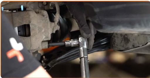
18 Installieren Sie die Staubschutzkappen der Bremssattel-Führungsstifte.
