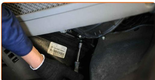
**9** Installieren und sichern Sie die Schutzabdeckung unter dem Handschuhfach.
