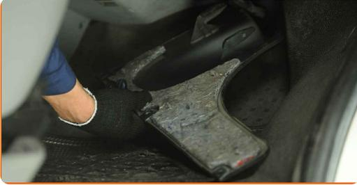
**10** Schrauben Sie die Befestigungen der Einstiegsverkleidung im Fahrgastbereich ein. Verwenden Sie den Torx T20. Verwenden Sie einen Ratschenschlüssel.
