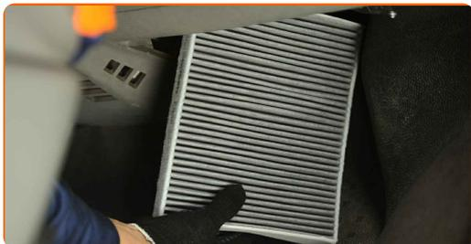
**Austausch: Innenraumfilter – VW California T5 Bus (7EC, 7EF, 7EG, 7HF).
