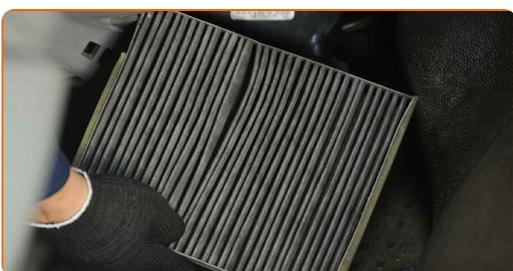
**Austausch: Innenraumfilter – VW California T5 Bus (7EC, 7EF, 7EG, 7HF). Tipp:**
