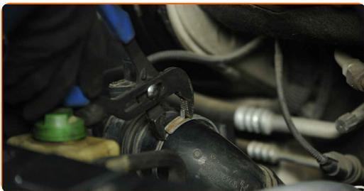
**32** Trennen Sie das Luftansaugrohr vom Luftfilter-Gehäuse.
