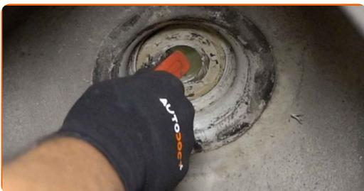
**55** Installieren Sie das Federbein am Radlauf.
