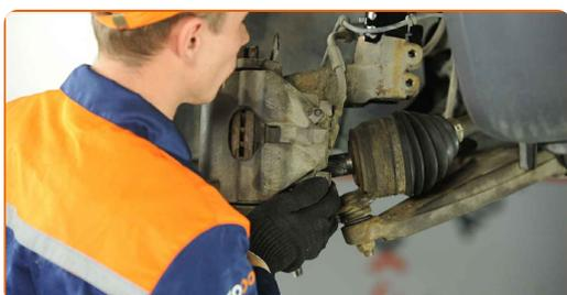
**25** Verbinden Sie das Kugelgelenk mit dem Achsschenkel.
