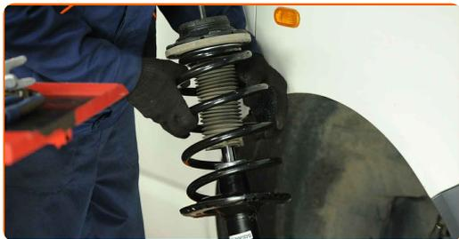
**56** Schrauben Sie die obere Befestigung des Domlagers an.
