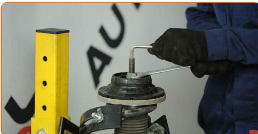
**46** Entfernen Sie das obere Domlager. Benutzen Sie ein Brecheisen.
