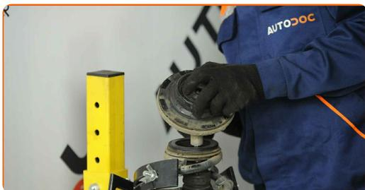
**47** Die Staubkappe des Stoßdämpfers und den Anschlagpuffer entfernen.
