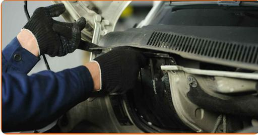
**60** Schrauben Sie die Befestigungsschrauben der Schutzabdeckung fest. Verwenden Sie den Torx T30. Verwenden Sie einen Ratschenschlüssel.
