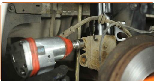
**22** Entfernen Sie die Befestigungsschrauben.
