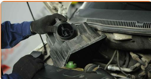
**64** Verbinden Sie das Luftansaugrohr mit dem Luftfilter-Gehäuse.
