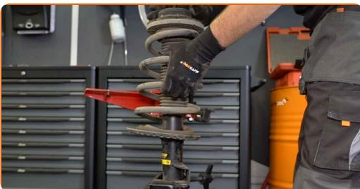
**Austausch: Domlager – VW California T5 Bus (7EC, 7EF, 7EG, 7HF). Tipp:**
