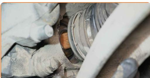
**77** Verbinden Sie das Kugelgelenk mit dem Achsschenkel.
