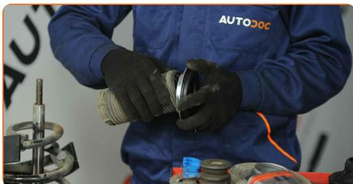
**49** Setzen Sie das neue obere Federbeinlager ein.
