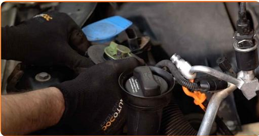
**7** Lösen Sie die Klemme und entfernen Sie den Einlassluftschlauch aus dem Filtergehäuse. Verwenden Sie eine Wasserpumpenzange.
