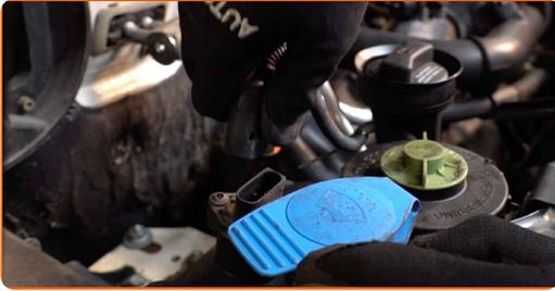
**6** Lösen Sie den Vorratsbehälter der Servolenkung.
