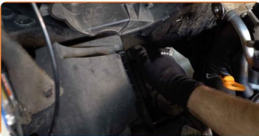
**9** Schrauben Sie die Filtergehäuse-Befestigungsbolzen ab. Verwenden Sie Inbusschlüssel Nr. H5.
