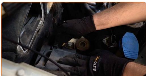
**17** Befestigen Sie den Luftansaugschlauch am Luftfiltergehäuse. Ziehen Sie die Kraftstofffilterklemme fest an.
