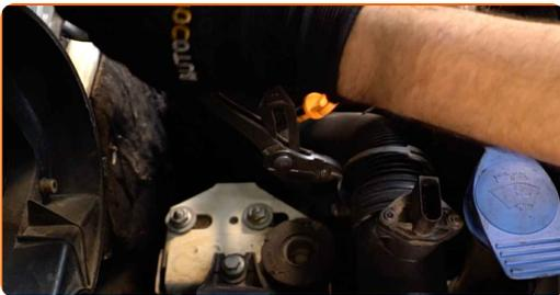
**8** Lösen Sie die Befestigungsclips der Luftfilterabdeckung.
