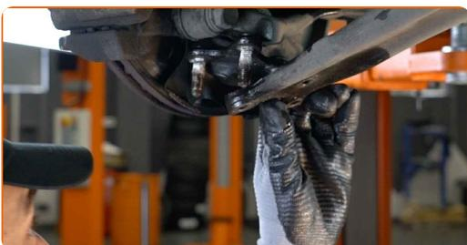
**24** Entfernen Sie die Antriebswelle. Verwenden Sie einen Splintentreiber.
