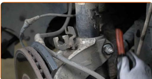
**19** Schrauben Sie das untere Befestigungselement ab, das das Federbein mit dem Achsschenkel verbindet. Verwenden Sie Stecknuss Nr. 18. Benutzen Sie den XZN #14. Verwenden Sie ein Windeisen. Verwenden Sie einen Ratschenschlüssel.
