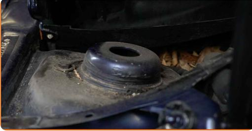
**6** Reinigen Sie die Befestigungselemente der oberen Federbeinhalterung. Benutzen Sie eine Drahtbürste. Benutzen Sie WD-40-Spray.
