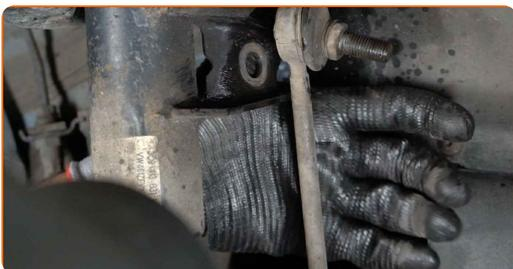
**17** Lösen Sie die Verdrahtung und den Bremsschlauch aus der Halterung am Federbein. Benutzen Sie ein Brecheisen.
