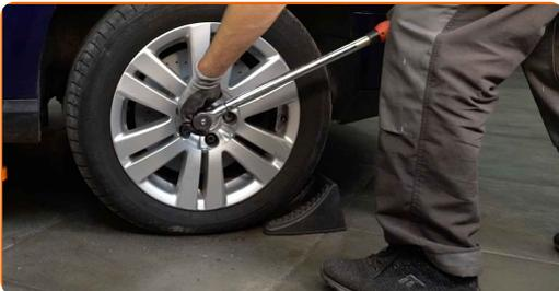
**77** Ziehen Sie die Schraube fest, welche die Antriebswelle mit der Radnabe verbindet. Benutzen Sie eine 12-Kant-Nuss #24. Verwenden Sie einen Drehmomentschlüssel. Ziehen Sie ihn mit 200 Nm Drehmoment fest.+180°
