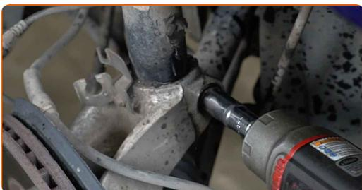
**20** Entfernen Sie die Befestigungsschraube. Benutzen Sie eine 12-Kant-Nuss #24.
