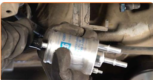
**12** Ziehen Sie die Befestigungsmittel des Treibstofffilters fest. Verwenden Sie einen Kreuzschlitzschraubendreher.
