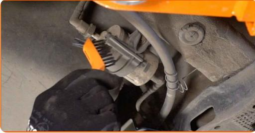
**6** Drücken Sie die Clips zusammen und lösen Sie die Kraftstoffzufuhrleitungen vom Kraftstofffiltergehäuse. Verwenden Sie einen flachen Schraubendreher.
