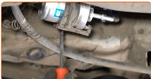
**13** Den Flüssigkeitsbehälter unter dem Kraftstofffilter entfernen.
