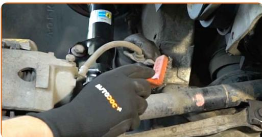
**40** Sichern Sie den Bremsschlauch-Befestigungswinkel.
