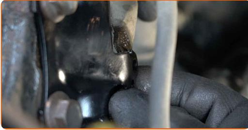
**41** Ziehen Sie die Befestigungsklammer des Bremsschlauchs am Federbein an. Verwenden Sie Stecknuss Nr. 10. Verwenden Sie einen Drehmomentschlüssel. Ziehen Sie ihn mit 13 Nm Drehmoment fest.
