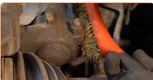
**12** Schrauben Sie das untere Befestigungselement ab, das das Federbein mit dem Achsschenkel verbindet. Verwenden Sie Ring-Gabelschlüssel Nr. 18. Verwenden Sie Stecknuss Nr. 18. Verwenden Sie einen Ratschenschlüssel.
