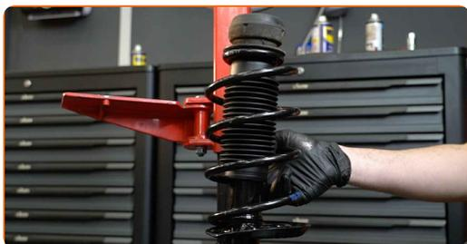
**36** Installieren Sie das Federbein am Radlauf.
