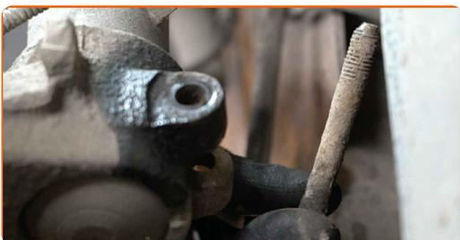
**14** Ziehen Sie den Achsschenkel vom Dämpferbein ab. Verwenden Sie einen Gummi-Hammer.
