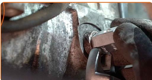
**15** Reinigen Sie den Bereich rund um die Einfüllöffnung des Getriebegehäuses. Verwenden Sie Allzweckreinigungsspray.
