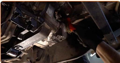
**6.2** Reinigen Sie den Bereich um die Ablassöffnung der Ölwanne. Benutzen Sie eine Drahtbürste. Benutzen Sie WD-40-Spray.
