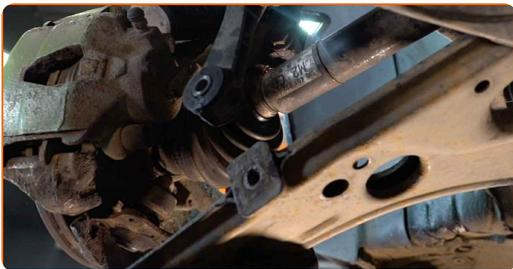
**15** Entfernen Sie den Arm. Benutzen Sie ein Brecheisen.
