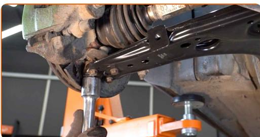
**22** Ziehen Sie das vordere Befestigungselement an, das den Querlenker mit dem Hilfsrahmen verbindet. Verwenden Sie Stecknuss Nr. 18. Verwenden Sie einen Drehmomentschlüssel. Ziehen Sie ihn mit 70 Nm Drehmoment fest.+90°
