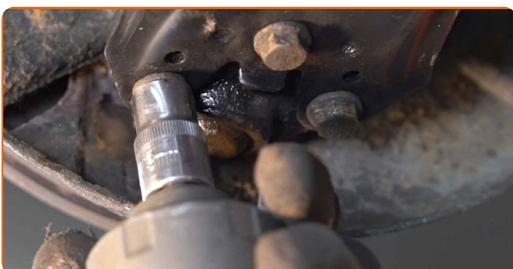
**21** Stützen Sie den Arm. Benutzen Sie einen hydraulischen Getriebeheber.
