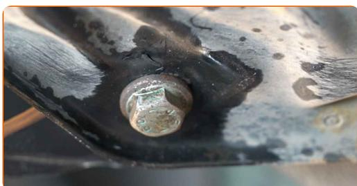
**19** Verbinden Sie das Kugelgelenk mit dem Lenker.
