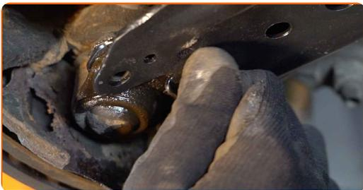
**20** Schrauben Sie die Befestigungen des Kugelgelenks ein. Verwenden Sie Stecknuss Nr. 13. Verwenden Sie einen Ratschenschlüssel.
