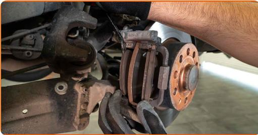
**Austausch: Bremsbeläge – VW Jetta IV (162, 163, AV3, AV2). AUTODOC-Experten empfehlen:**
