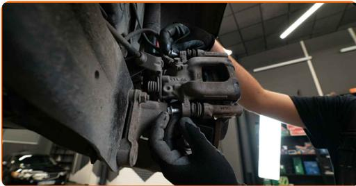
**Austausch: Bremsbeläge – VW Jetta IV (162, 163, AV3, AV2). Tipp von AUTODOC-Experten:**
