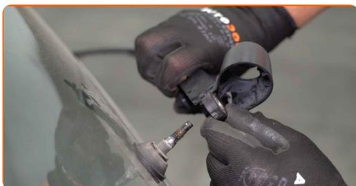
**19** Reinigen Sie den Montagesitz des hinteren Wischerarms. Benutzen Sie eine Drahtbürste. Benutzen Sie WD-40-Spray.
