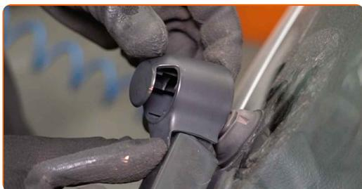
**16** Reinigen Sie die Befestigung des hinteren Wischerarms. Benutzen Sie eine Drahtbürste. Benutzen Sie WD-40-Spray.
