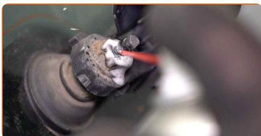
**17** Lösen Sie die Befestigung des hinteren Wischerarms. Verwenden Sie Stecknuss Nr. 13. Verwenden Sie einen Ratschenschlüssel.
