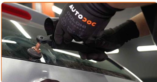
**22** Schrauben Sie die Befestigung des hinteren Wischerarms an. Verwenden Sie Stecknuss Nr. 13. Verwenden Sie einen Drehmomentschlüssel. Ziehen Sie ihn mit 16 Nm Drehmoment fest.
