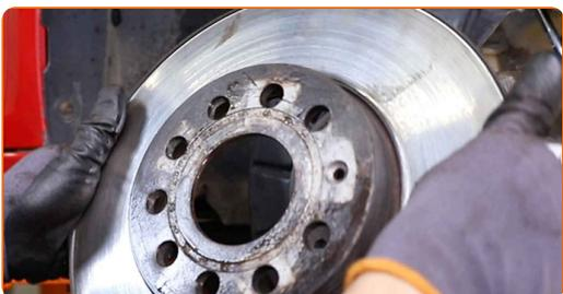
**20** Reinigen Sie die Nabe. Benutzen Sie eine Drahtbürste.
