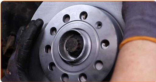
**23** Ziehen Sie die Befestigung der Bremsscheibe fest. Verwenden Sie den Torx T30. Verwenden Sie einen Drehmomentschlüssel. Ziehen Sie ihn mit 4 Nm Drehmoment fest.
