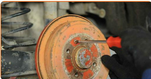
**8** Entfernen Sie die Bremstrommel.
