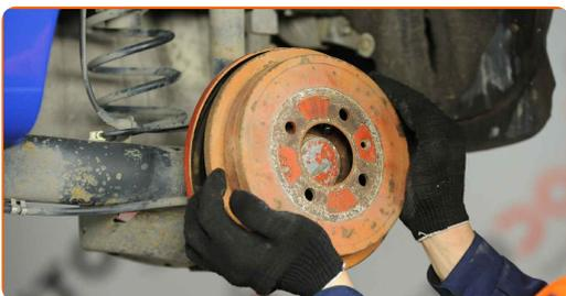
**Austausch: Bremstrommeln – VW load up! Kastenwagen (121, 122, BL1, BL2).**
