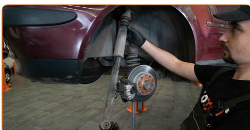
**12** Entfernen Sie die Schutzkappe der Stoßdämpferhalterung.
