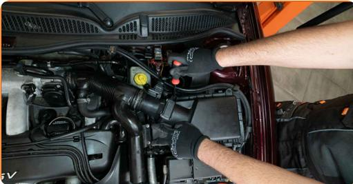
**4** Ziehen Sie den Stecker des Luftmassenmessers ab. Lösen Sie die Klemme und entfernen Sie den Einlassluftschlauch aus dem Filtergehäuse. Verwenden Sie eine Kombizange.
