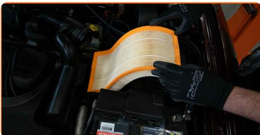
**Austausch: Luftfilter – VW LT 28-46 II Kastenwagen (2DA, 2DD, 2DH). Tipp von AUTODOC-Experten:**
