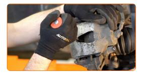
Entfernen Sie die Bremsbeläge. Benutzen Sie ein Brecheisen.
