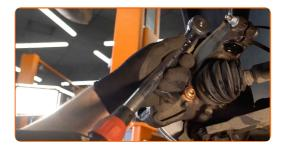
Installieren Sie die Staubschutzkappen der Bremssattel-Führungsstifte.
