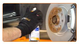
Die Bremsscheibenoberfläche reinigen. Benutzen Sie einen Bremsenreiniger.
