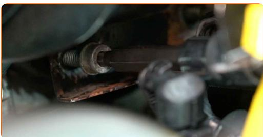
**9** Entfernen Sie die Sekundärluftpumpenhalterung.
