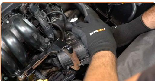
**8** Drehen Sie das Befestigungselement der Sekundärluftpumpenhalterung auf. Verwenden Sie Inbusschlüssel Nr. H6. Verwenden Sie Stecknuss Nr. 13. Verwenden Sie einen Ratschenschlüssel.
