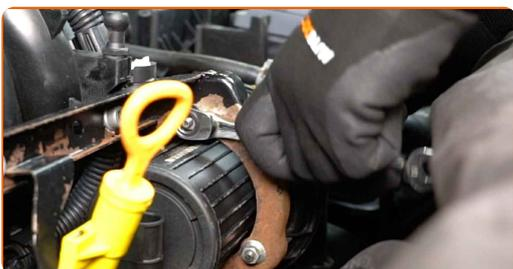
**7** Entfernen Sie die Sekundärluftpumpe.
