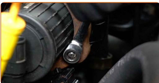
**24** Befestigen Sie den Stecker der Sekundärluftpumpe.
