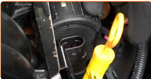
**6** Drehen Sie die Befestigungen auf, die die Sekundärluftpumpe mit ihrer Halterung verbinden. Verwenden Sie Ring-Gabelschlüssel Nr. 10.
