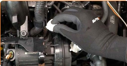
**5** Ziehen Sie den Stecker der Sekundärluftpumpe ab.
