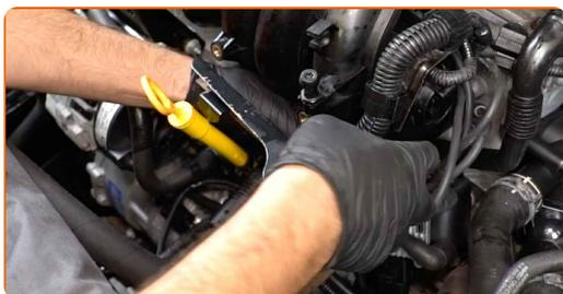
**21** Ziehen Sie das Befestigungselement der Sekundärluftpumpenhalterung fest. Verwenden Sie Inbusschlüssel Nr. H6. Verwenden Sie Stecknuss Nr. 13. Verwenden Sie einen Drehmomentschlüssel. Ziehen Sie ihn mit 9 Nm Drehmoment fest.
