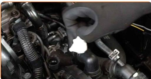
**26** Befestigen Sie die Schläuche der Sekundärluftpumpe.
