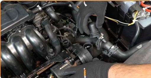
**4** Decken Sie die Kanäle der Sekundärluftpumpe mit einem Mikrofasertuch ab, damit kein Staub und Schmutz ins Innere gelangen kann.
