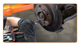
15 Entfernen Sie die Bremsscheibe.
