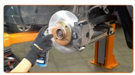
Die Bremsscheibenoberfläche reinigen. Benutzen Sie einen Bremsenreiniger.
