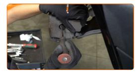
Entfernen Sie den Bremssattel.
