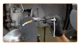
Installieren Sie den Bremssattel und fixieren Sie diesen. Verwenden Sie Inbusschlüssel Nr. H6. Verwenden Sie einen Drehmomentschlüssel. Ziehen Sie ihn mit 25 Nm Drehmoment fest.
