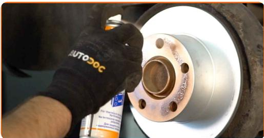
**33** Die Bremsscheibenoberfläche reinigen. Benutzen Sie einen Bremsenreiniger.
