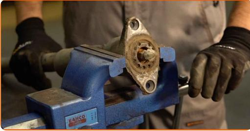
**15** Reinigen Sie die Befestigungen vom Stoßdämpferschaft. Benutzen Sie eine Drahtbürste. Benutzen Sie WD-40-Spray.
