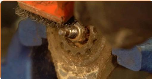
**16** Entfernen Sie die Befestigung der Stoßdämpferkolbenstange. Verwenden Sie einen Stoßdämpfer Steckschlüsseinsatz Nr. 5. Verwenden Sie Stecknuss Nr. 17. Verwenden Sie einen Ratschenschlüssel.
