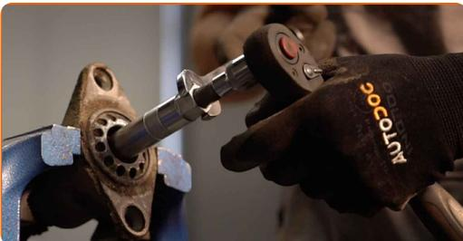
**17** Entfernen Sie die Stoßdämpferhalterung, die Manschette und den Stoßstopp.
