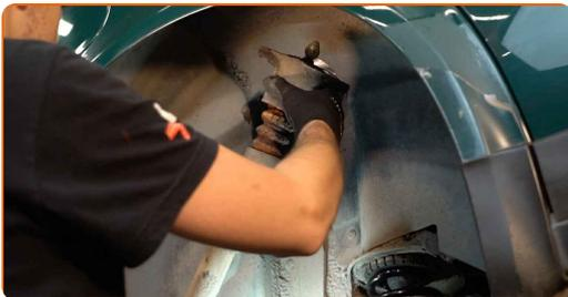
**14** Greifen Sie den Stoßdämpfer mit einem Schraubstock.
