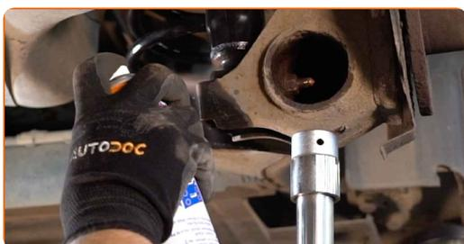
**24** Die Montage unter dem Hinterachsträger entfernen.
