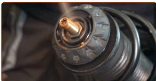
**35** Reinigen Sie die Anbringungssitze des Federbeins. Benutzen Sie eine Drahtbürste. Benutzen Sie WD-40-Spray.
