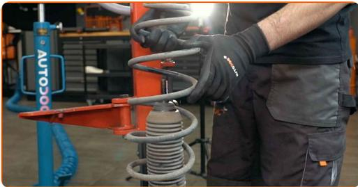
**24** Die Staubkappe des Stoßdämpfers und den Anschlagpuffer entfernen.
