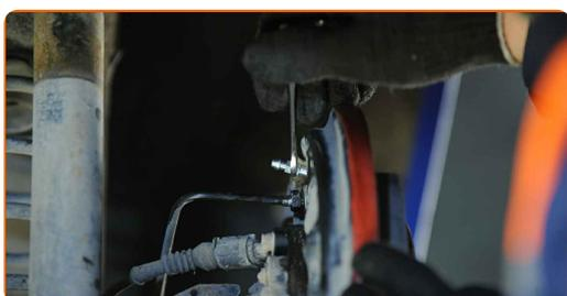
**Austausch: Radbremszylinder – VW Polo Coupe (86C, 80). Fachleute empfehlen:**
