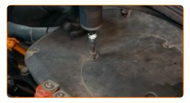
Entfernen Sie das Luftfiltergehäuse.
