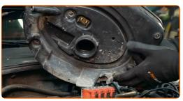
Bedecken Sie die Drosselklappe mit einem Mikrofasertuch, um zu vermeiden, dass Staub und Schmutz in das System gelangen.
