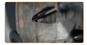
Entfernen Sie die Staubschutzkappen der Bremssattel-Führungsstifte. Verwenden Sie einen flachen Schraubendreher.
