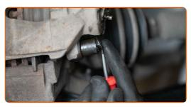
Verbinden Sie die ABS-Sensor Steckdose. Verbinden Sie den Stecker des Verschleißseonsors der Bremsbeläge.
