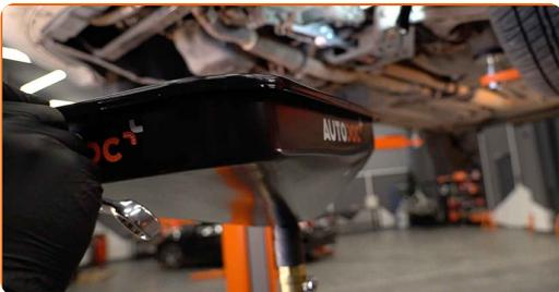
**8** Drehen Sie die Ablassschraube heraus. Verwenden Sie Inbusschlüssel Nr. H17.
