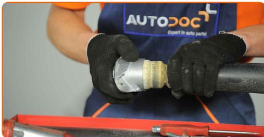
**17** Schrauben Sie die untere Befestigung der Federbeinkolbenstange an. Verwenden Sie Stecknuss Nr. 16. Verwenden Sie einen Drehmomentschlüssel. Ziehen Sie ihn mit 25 Nm Drehmoment fest.
