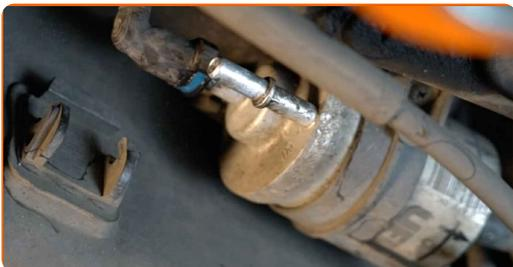
Austausch: Kraftstofffilter – VW POLO VIVO Stufenheck. AUTODOC-Experten empfehlen:
