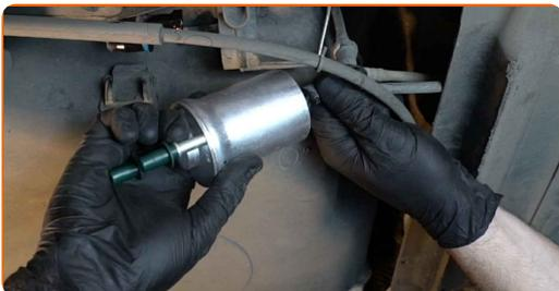
**12** Installieren Sie einen neuen Kraftstofffilter.
