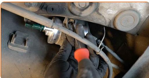
**14** Verbinden Sie die Kraftstoffversorgungsleitungen zum Kraftstofffilter.
