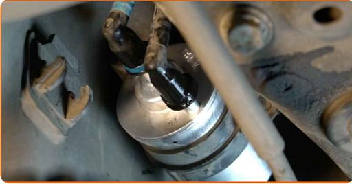
**15** Den Flüssigkeitsbehälter unter dem Kraftstofffilter entfernen.
