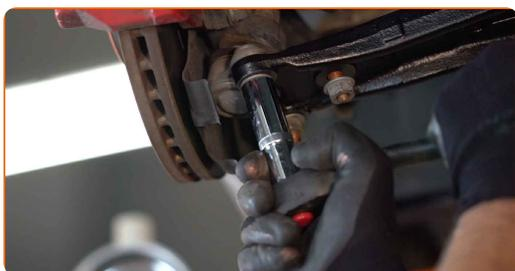
**18** Schrauben Sie das hintere Befestigungselement ein, das den Querlenker mit dem Hilfsrahmen verbindet. Verwenden Sie Stecknuss Nr. 15. Verwenden Sie Stecknuss Nr. 18. Verwenden Sie einen Ratschenschlüssel.
