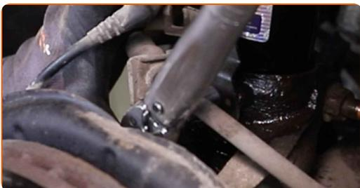
**78** Verbinden Sie das ABS mit der Sensorverdrahtung.
