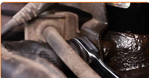
**77** Ziehen Sie die Befestigungsklammer des Bremsschlauchs am Federbein an. Verwenden Sie Stecknuss Nr. 10. Verwenden Sie einen Drehmomentschlüssel. Ziehen Sie ihn mit 12 Nm Drehmoment fest.
