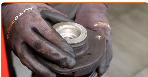
**50** Ziehen Sie die Federbeinkolbenstangenmutter an. Verwenden Sie eine 21 mm Schienenmutterstecknuss. Verwenden Sie Inbusschlüssel Nr. H6. Verwenden Sie einen Drehmomentschlüssel. Ziehen Sie ihn mit 60 Nm Drehmoment fest.
