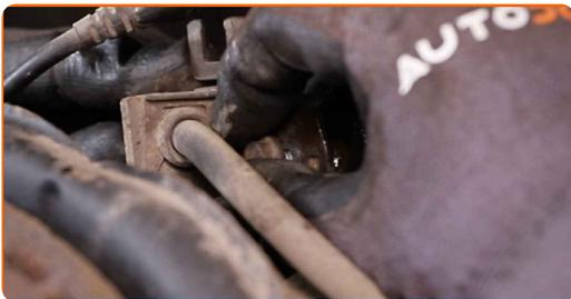
**76** Ziehen Sie die Befestigung an, die die Halterung des Bremsschlauchs mit dem Federbein verbindet. Verwenden Sie Ring-Gabelschlüssel Nr. 10.
