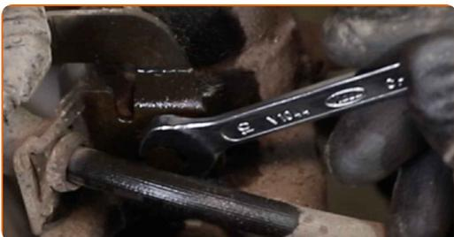
**21** Entfernen Sie die Halterung des Bremsschlauchs.
