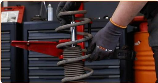
**43** Entfernen Sie die Staubmanschette.
