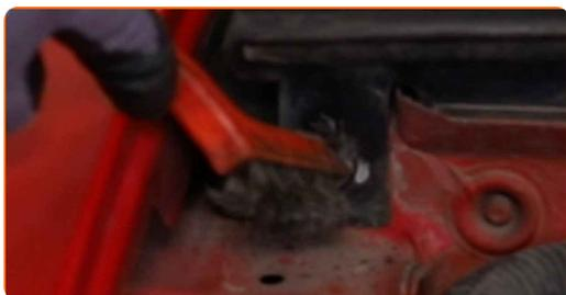
**4** Schrauben Sie die Befestigung der Kunststoffplatte ab. Verwenden Sie den Torx T30. Verwenden Sie einen Ratschenschlüssel.
