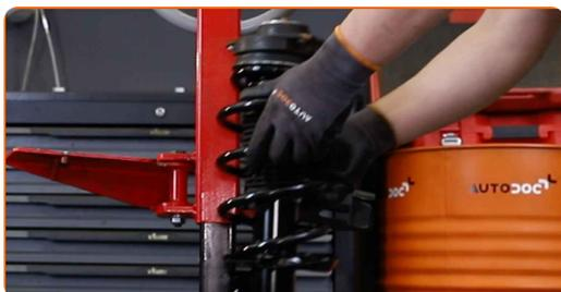
**54** Reinigen Sie die Anbringungssitze des Federbeins. Benutzen Sie eine Drahtbürste. Benutzen Sie WD-40-Spray.
