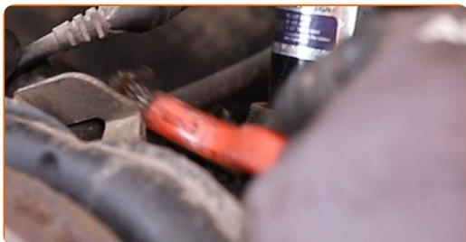
**75** Installieren Sie die Halterung des Bremsschlauchs.
