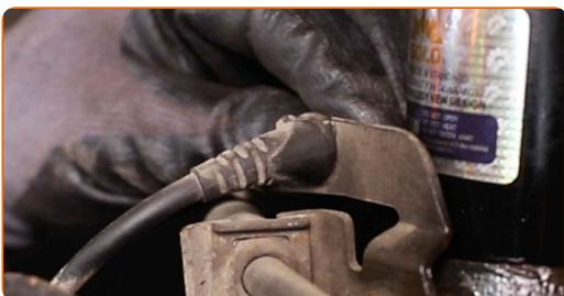
**79** Reinigen Sie die Oberfläche an welcher die Felge montiert werden soll. Benutzen Sie eine Drahtbürste.
