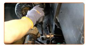
Schrauben Sie die Befestigungen der Koppelstange ein. Verwenden Sie Ring-Gabelschlüssel Nr. 16. Verwenden Sie Stecknuss Nr. 19. Verwenden Sie einen Ratschenschlüssel.
