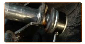
Ziehen Sie das Befestigungselement an, das die Druckstange mit dem Stabilisator verbindet. Verwenden Sie Stecknuss Nr. 17. Verwenden Sie einen Drehmomentschlüssel. Ziehen Sie ihn mit 100 Nm Drehmoment fest.
