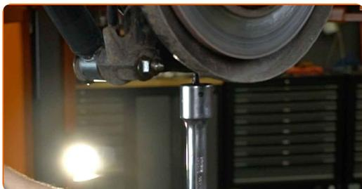
**7** Reinigen Sie die untere Stoßdämpferbefestigung. Benutzen Sie eine Drahtbürste. Benutzen Sie WD-40-Spray.
