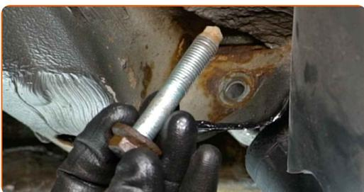
**15** Den Stoßdämpfer entfernen.
