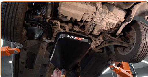
**12** Reinigen Sie den Bereich um die Ablassöffnung der Ölwanne. Benutzen Sie eine Drahtbürste. Benutzen Sie WD-40-Spray.
