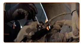
Schrauben Sie die Haltevorrichtung heraus, die den Bremsschlauch mit dem Bremssattel verbindet. Verwenden Sie Ring-Gabelschlüssel Nr. 10.
