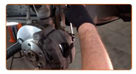
Ziehen Sie die Bremsentlüftungsschraube an. Verwenden Sie Ring-Gabelschlüssel Nr. 11.
