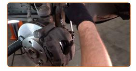
Trennen Sie den Schlauch des Bremsentlüftungs-Kits.
