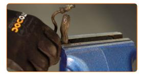
Schrauben Sie die Bremsleitung vom Bremsschlauch los. Verwenden Sie Zangen. Trennen Sie den Bremsschlauch.
