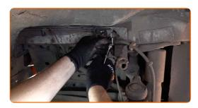
Entfernen Sie den Bremsschlauch, der mit der Haltevorrichtung zusammengebaut ist.
