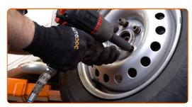
Senken Sie das Auto und ziehen Sie die Radschrauben über Kreuz an. Verwenden Sie einen Drehmomentschlüssel. Ziehen Sie ihn mit 170 Nm Drehmoment fest.
