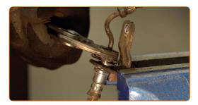
Entfernen Sie die Bremsleitung von der Haltevorrichtung.
