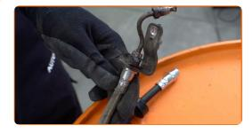
Klemmen Sie die Haltevorrichtung des Bremsschlauchs in den Schraubstock.
