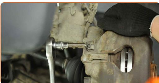
**11** Entfernen Sie die Bremssattelführungsbolzen.
