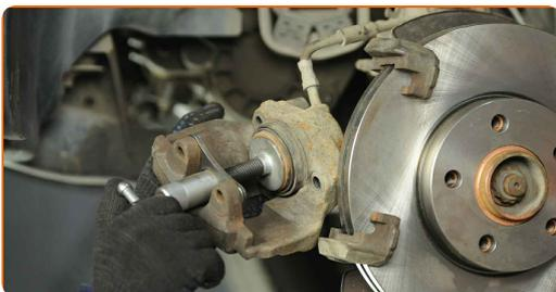
**17** Behandeln Sie die Bremsbeläge in dem Bereich, wo ihre Oberfläche mit dem Bremssattelhalter in Berührung tritt. Benutzen Sie eine Anti-Quietsch-Paste.
