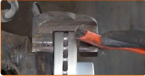
**15** Behandeln Sie den Bremssattel-Kolben. Verwenden Sie eine Nylon-Reinigungsbürste. Benutzen Sie einen Bremsenreiniger.
