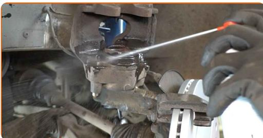
**16** Drücken Sie den Bremssattelkolben rein. Verwenden Sie den Bremskolbenrücksteller.
