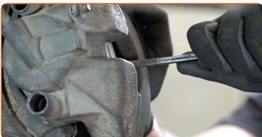
**10** Schrauben Sie die Befestigungen des Bremssattels ab. Verwenden Sie Inbusschlüssel Nr. H7. Verwenden Sie einen Ratschenschlüssel.
