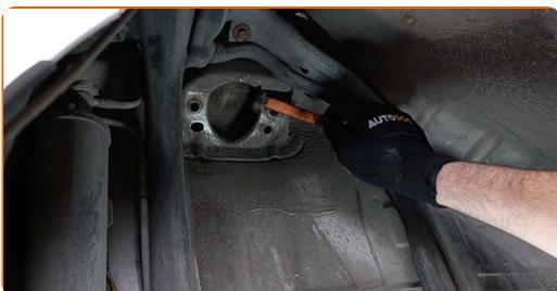
**40** Installieren Sie das Federbein am Radlauf.
