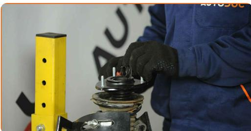
**37** Dekomprimieren Sie die Feder.
