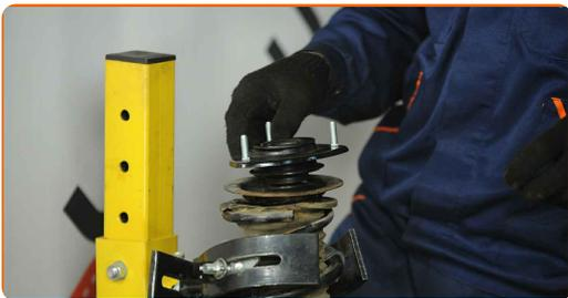
**34** Ziehen Sie die Federbeinkolbenstangenmutter an. Verwenden Sie Stecknuss Nr. 17. Verwenden Sie einen Drehmomentschlüssel. Ziehen Sie ihn mit 33 Nm Drehmoment fest.
