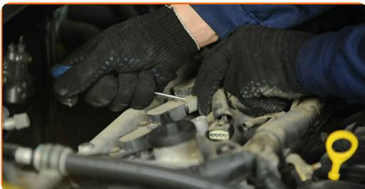
**6** Schrauben Sie die Befestigungsschrauben der Zündspulen ab. Verwenden Sie Stecknuss Nr. 10. Verwenden Sie einen Ratschenschlüssel.
