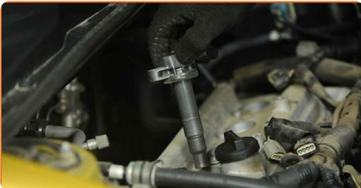
**15** Ziehen Sie die Befestigungen der Zündspulen fest. Verwenden Sie Stecknuss Nr. 10. Verwenden Sie einen Ratschenschlüssel.
