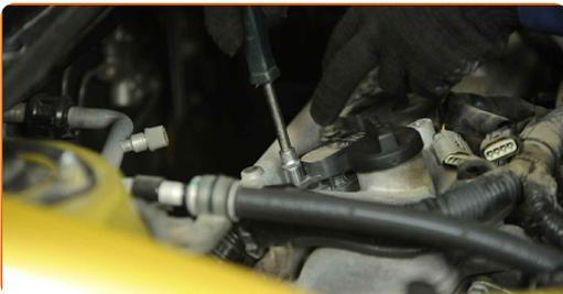
**16** Behandeln Sie den Zündspulenanschluss mit einem Elektronikspray. Das Spray wird die elektrischen Kontakte vor Korrosion und Oxidation schützen und den Kontaktwiderstand reduzieren.
