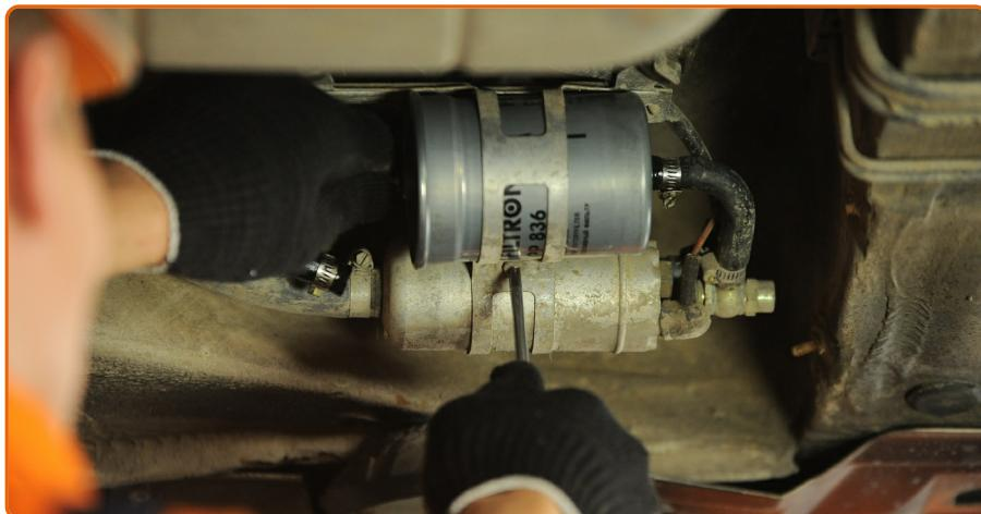
Ziehen Sie die Befestigungsklemme der Kraftstoffversorgungsleitung an. Verwenden Sie einen flachen Schraubendreher.
