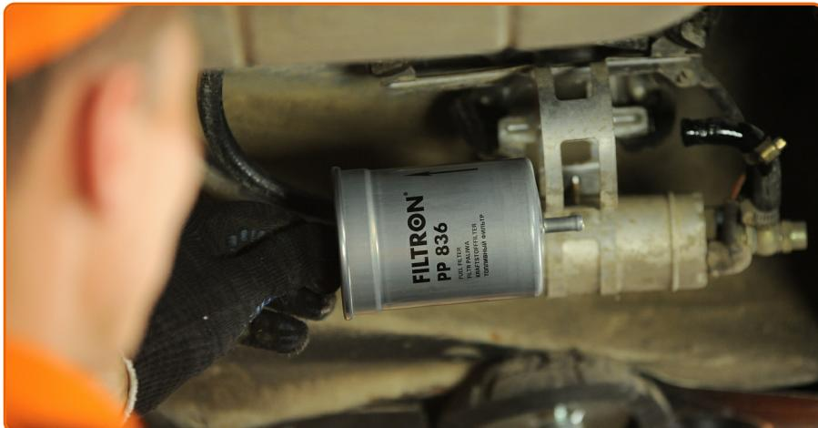
Installieren Sie einen neuen Kraftstofffilter.
