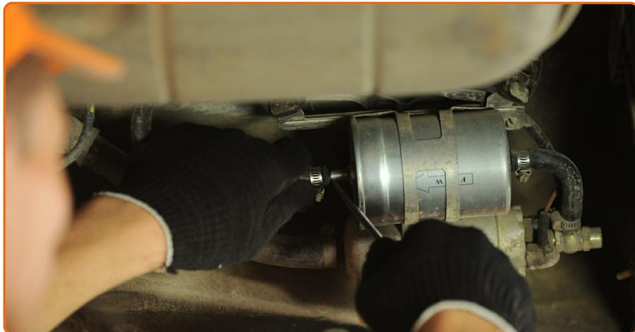
Trennen Sie die Leitung vom Kraftstofffilter. Verwenden Sie einen flachen Schraubendreher.
