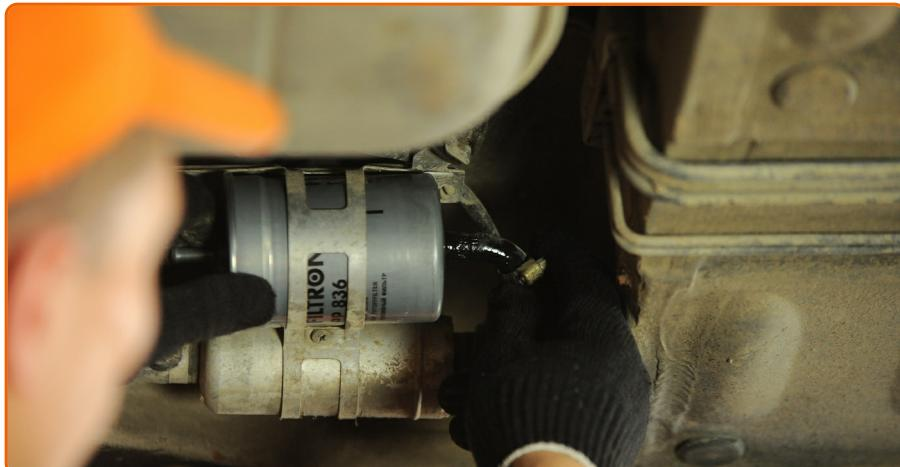
Befestigen Sie die Leitung am Kraftstofffilter.
