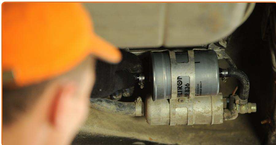
Befestigen Sie die Leitung am Kraftstofffilter.
