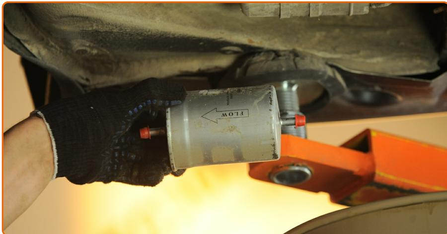
Entfernen Sie den Kraftstofffilter.
