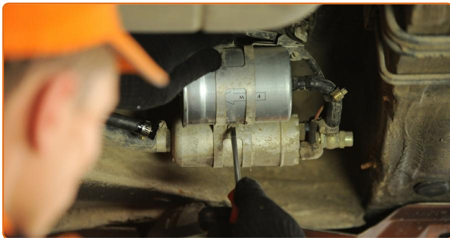
Schrauben Sie die Befestigungsbolzen der Treibstofffilterhalterung ab. Verwenden Sie einen Kreuzschlitzschraubendreher.
