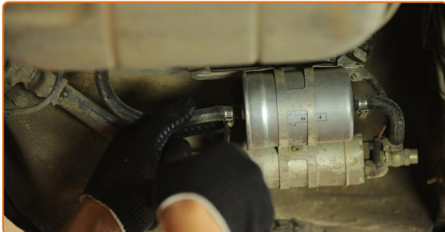
Lockern Sie die Befestigungsklemme der Kraftstofffilterleitung. Verwenden Sie einen flachen Schraubendreher.
