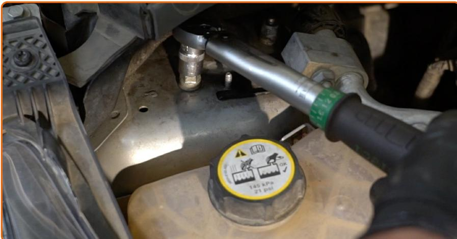
Ziehen Sie die obere Befestigung des Domlagers fest. Verwenden Sie Ring-Gabelschlüssel Nr. 13. Verwenden Sie Stecknuss Nr. 13. Verwenden Sie einen Drehmomentschlüssel. Ziehen Sie ihn mit 41 Nm Drehmoment fest.
