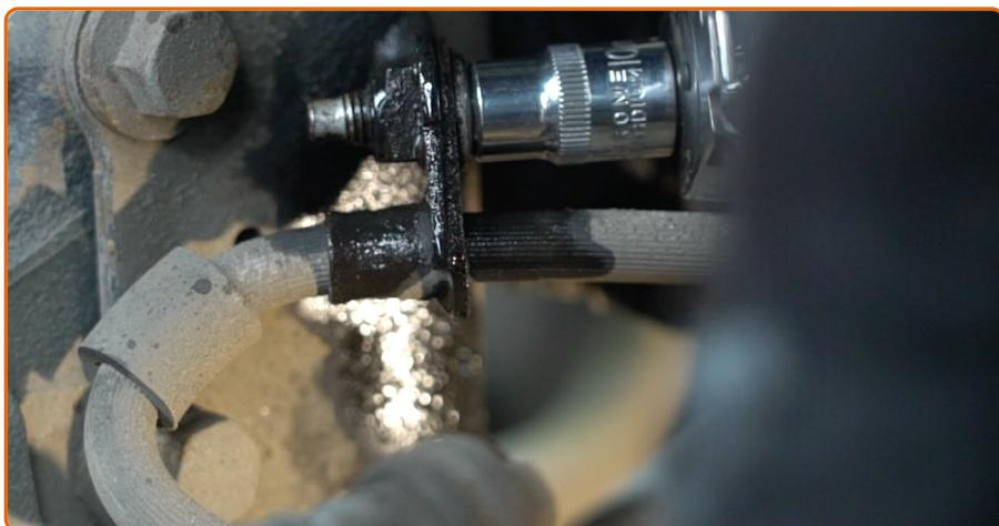
Trennen Sie den Bremsschlauchhalter vom Dämpferbein. Verwenden Sie Stecknuss Nr. 10. Verwenden Sie einen Ratschenschlüssel.
