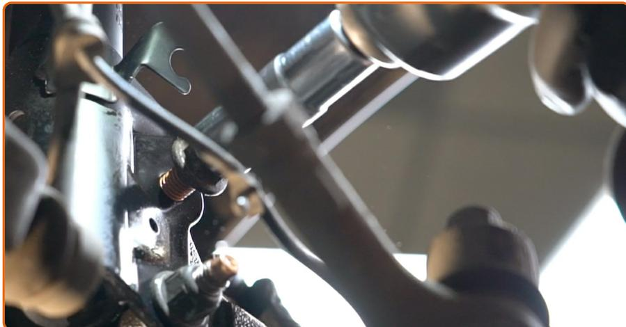
Schrauben Sie das Befestigungselement ein, das das Federbein mit dem Achsschenkel verbindet. Verwenden Sie Ring-Gabelschlüssel Nr. 15. Verwenden Sie Stecknuss Nr. 18. Verwenden Sie einen Ratschenschlüssel.
