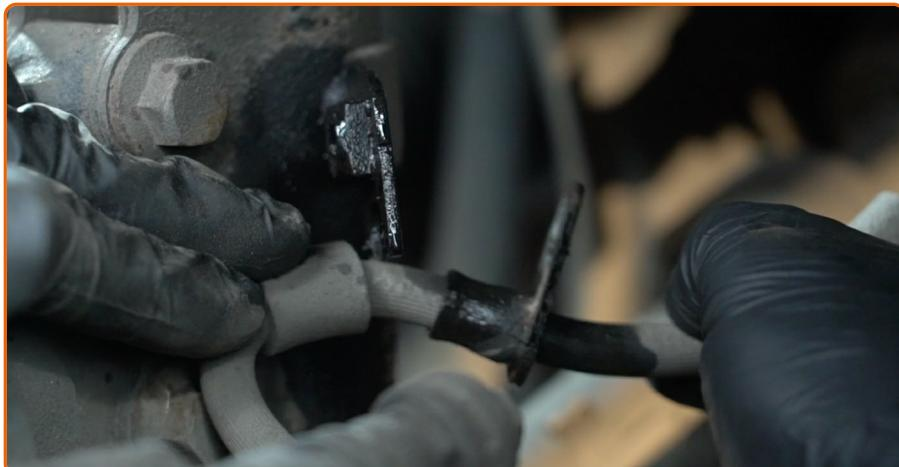
Lösen Sie den Bremsschlauch vom Federbein.
