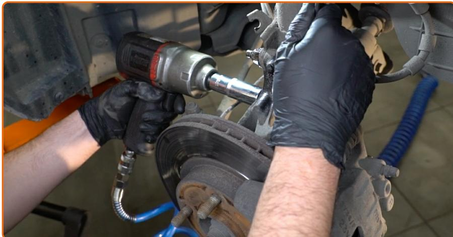
Schrauben Sie das untere Befestigungselement ab, dass das Federbein mit dem Achsschenkel verbindet. Verwenden Sie Ring-Gabelschlüssel Nr. 15. Verwenden Sie Stecknuss Nr. 18. Verwenden Sie einen Ratschenschlüssel.
