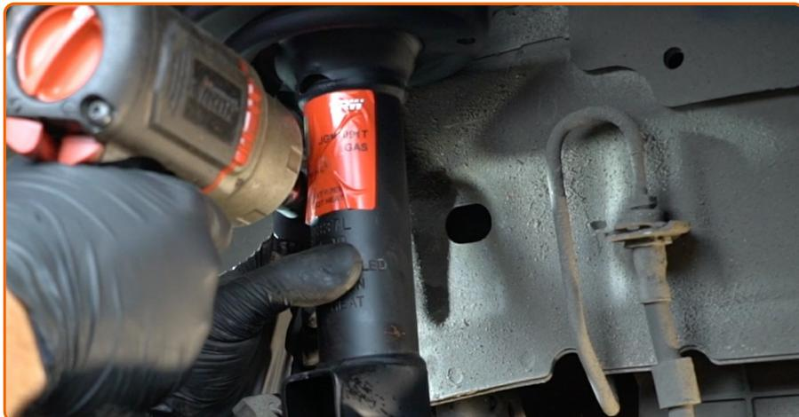
Ziehen Sie die Befestigungselemente des Stabilenkers fest. Verwenden Sie Stecknuss Nr. 15.
