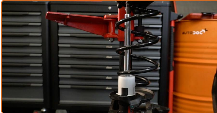
Installieren Sie die Feder am Stoßdämpfer.
