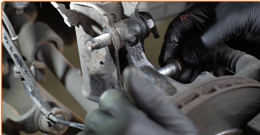
Entfernen Sie die Befestigungsschrauben.
