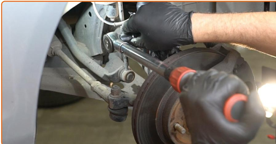
Ziehen Sie die unteren Befestigungen an, die das Federbein mit dem Achsschenkel verbinden. Verwenden Sie Ring-Gabelschlüssel Nr. 15. Verwenden Sie Stecknuss Nr. 18. Verwenden Sie einen Drehmomentschlüssel. Ziehen Sie ihn mit 77 Nm Drehmoment fest.
