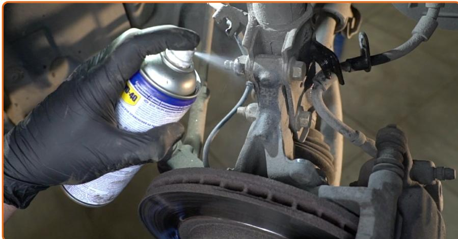
Die Befestigungselemente, die das Federbein mit dem Achsschenkel verbinden, reinigen.
