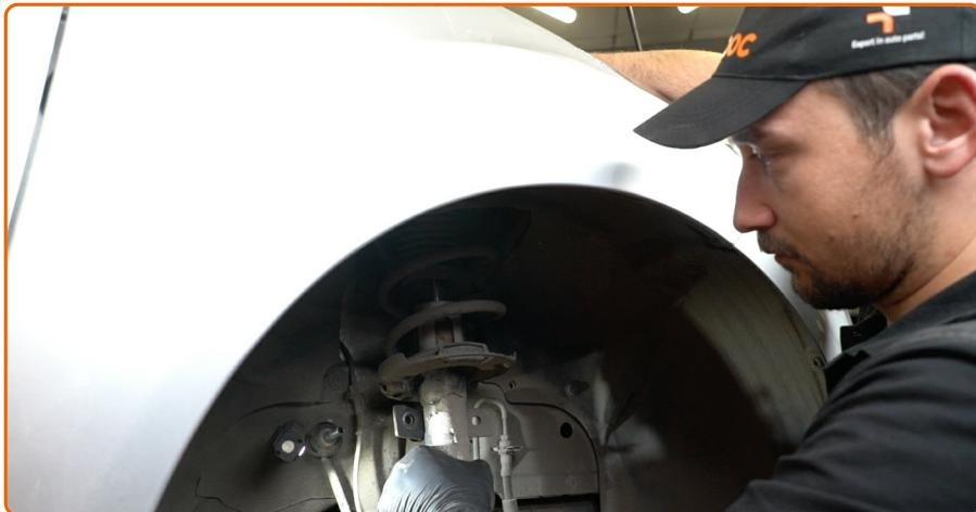
Lösen Sie die obere Befestigung des Domlagers.
