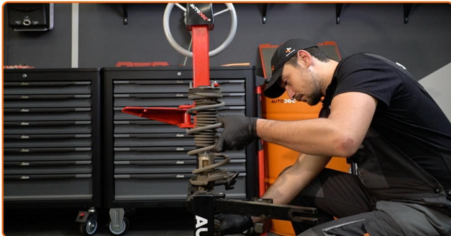
Stellen Sie das Dämpferbein auf das Federspannwerkzeug.
