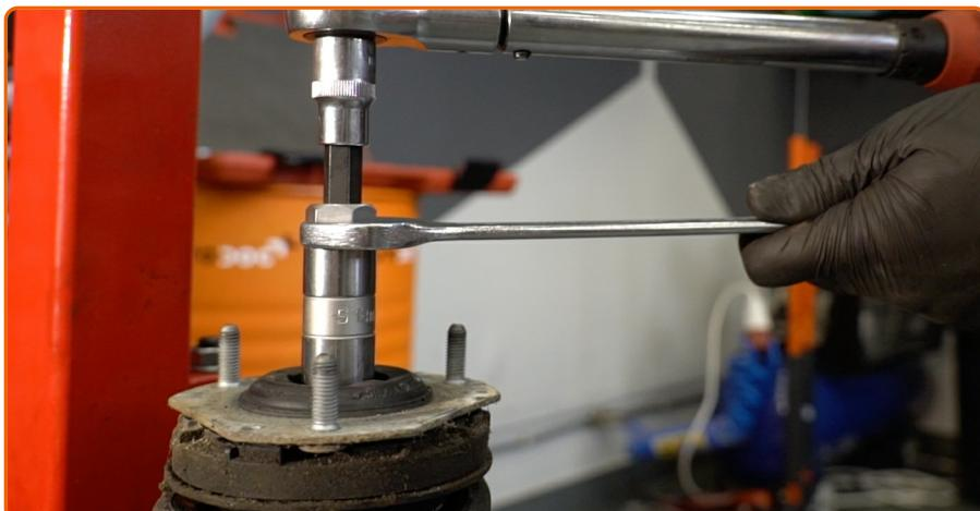
Ziehen Sie die Federbeinkolbenstangenmutter an. Verwenden Sie Inbusschlüssel Nr. H6. Verwenden Sie Stecknuss Nr. 18. Verwenden Sie einen Drehmomentschlüssel. Ziehen Sie ihn mit 60 Nm Drehmoment fest.
