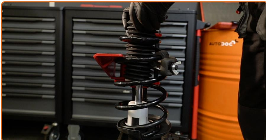
Installieren Sie die Manschette und eine Stoßstopp auf den Stoßdämpfer.
