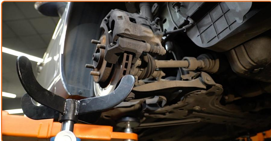
Stützen Sie die Achsschenkel auf. Benutzen Sie einen hydraulischen Getriebeheber.
