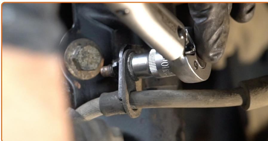
Verwenden Sie Stecknuss Nr. 10. Verwenden Sie einen Drehmomentschlüssel. Ziehen Sie ihn mit 7 Nm Drehmoment fest.
