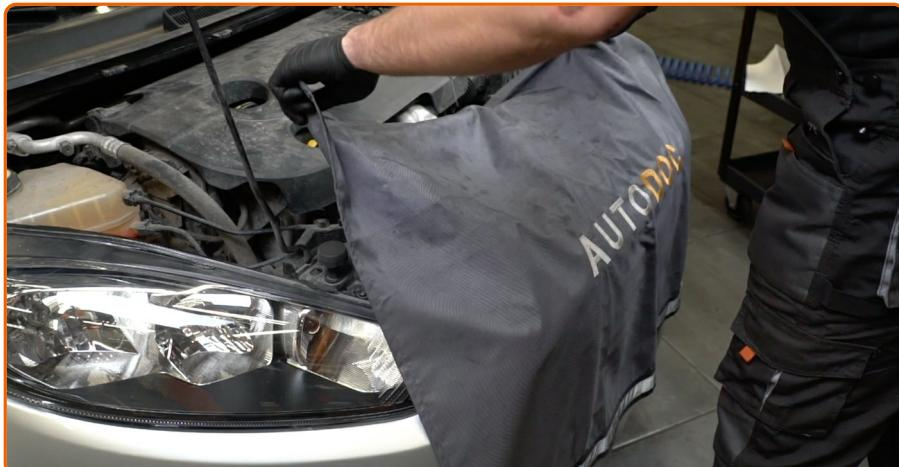
Entfernen Sie die Kotflügel-Abdeckung.
