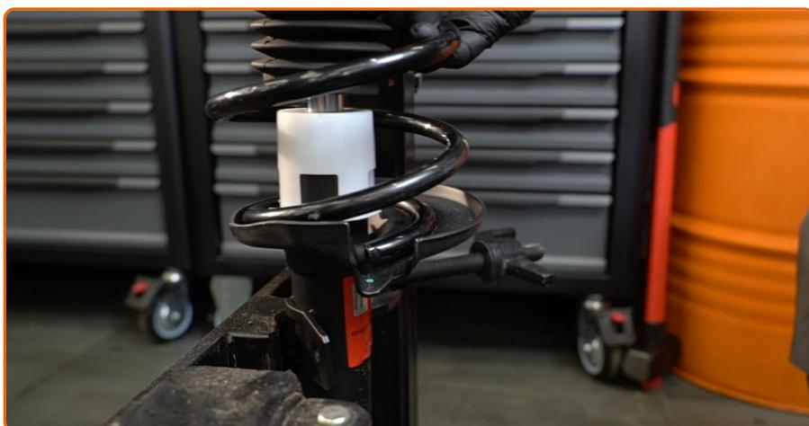
Entfernen Sie das zusammengebaute Federbein.
