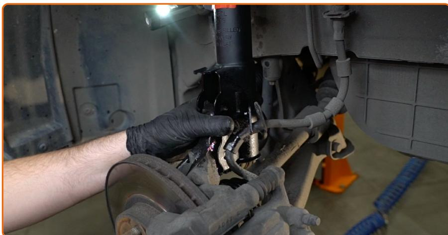
Befestigen Sie das Dämpferbein auf dem Achsschenkel.
