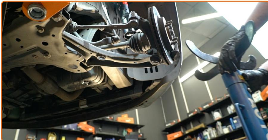
Entfernen Sie den Träger unter dem Achsschenkel.
