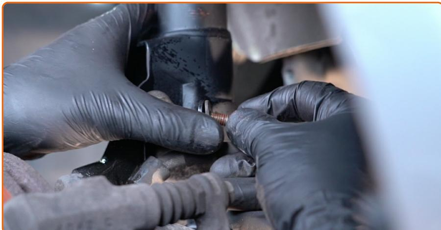
Befestigen Sie den Bremsschlauch an der Strebe.
