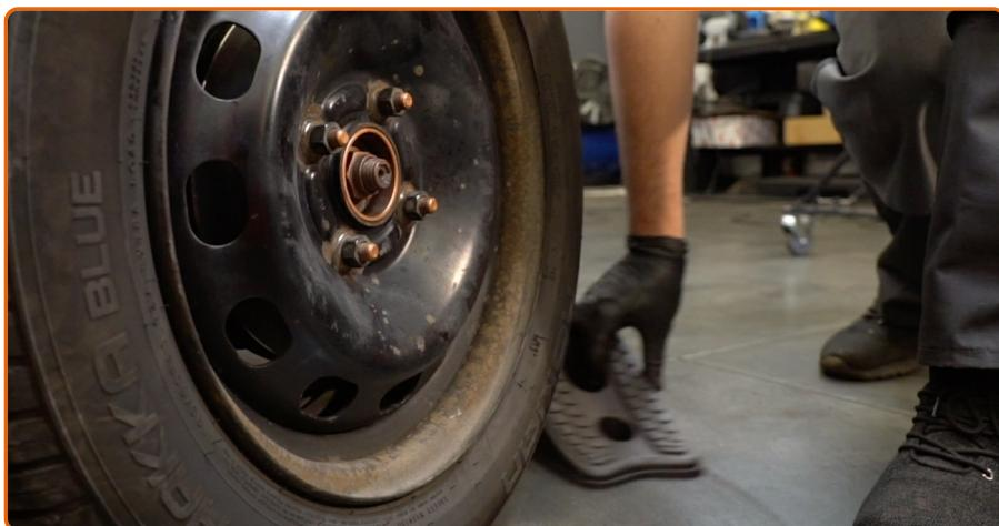
Entfernen Sie den Wagenheber sowie die Unterlegkeile.
