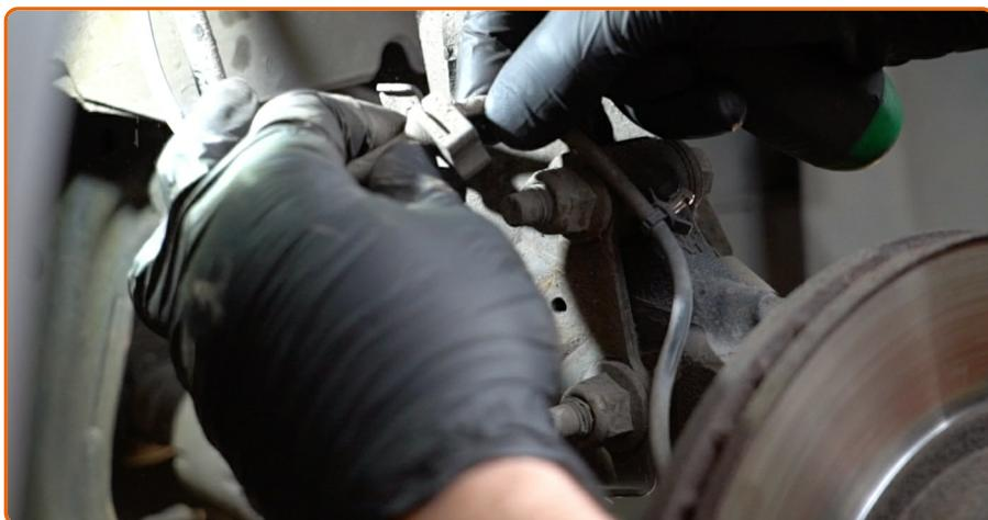
Trennen Sie die ABS Sensorverdrahtung. Verwenden Sie einen Lösehebel, um die Clips zu entfernen.
