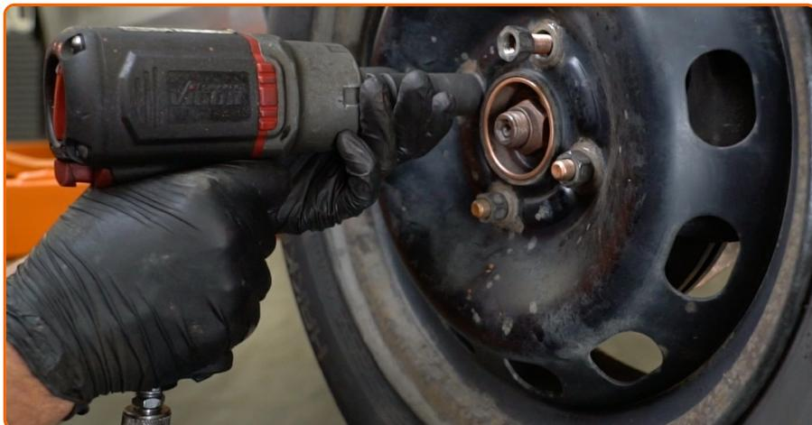
Schrauben Sie die Radbolzen fest. Verwenden Sie eine Schlagnuss für Felgen # 19.
