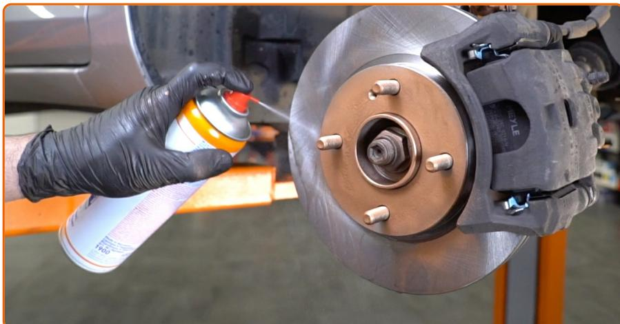
Die Bremsscheibenoberfläche reinigen. Benutzen Sie einen Bremsenreiniger.
