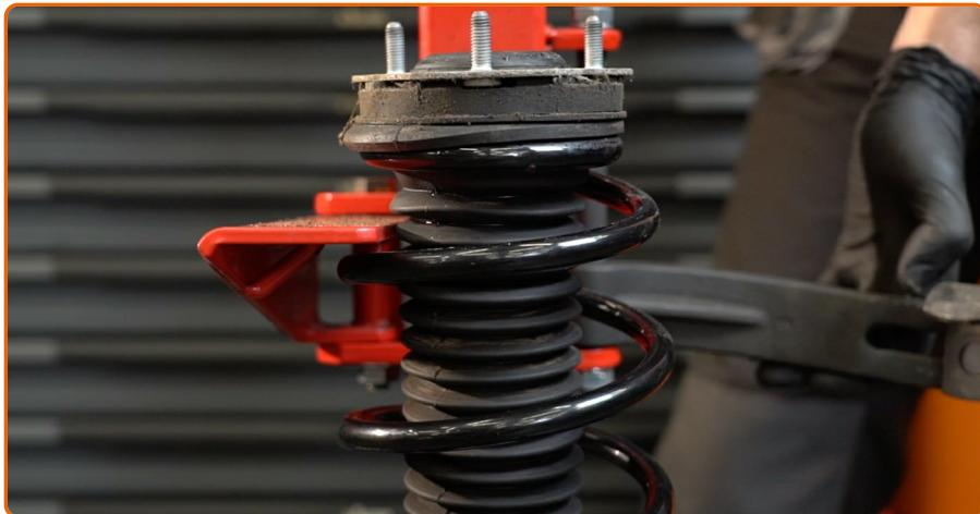
Dekomprimieren Sie die Feder.
