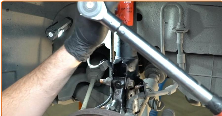
Ziehen Sie das Befestigungselement an, das die Druckstange mit dem Federbein verbindet.
