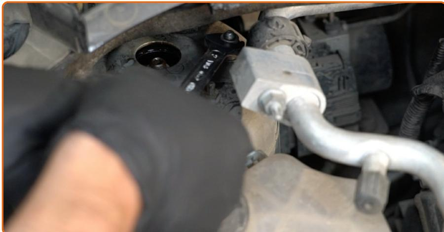
Lösen Sie die obere Befestigung des Domlagers. Verwenden Sie Ring-Gabelschlüssel Nr. 13.
