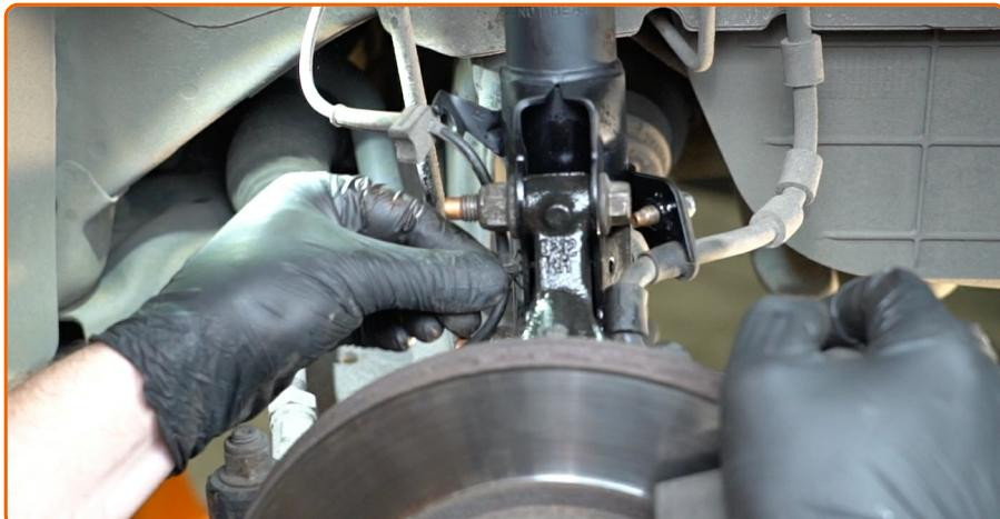
Verbinden Sie das ABS mit der Sensorverdrahtung.
