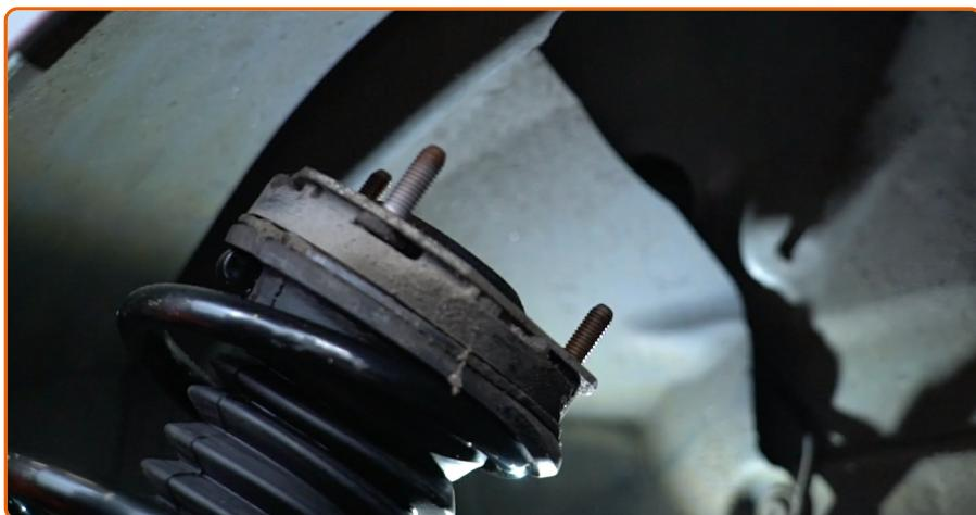
Installieren Sie das Federbein am Radlauf.
