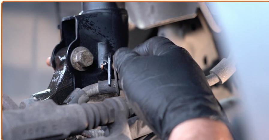
Schließen Sie den Bremsbelagverschluss an der Stoßdämpferstrebbe an.
