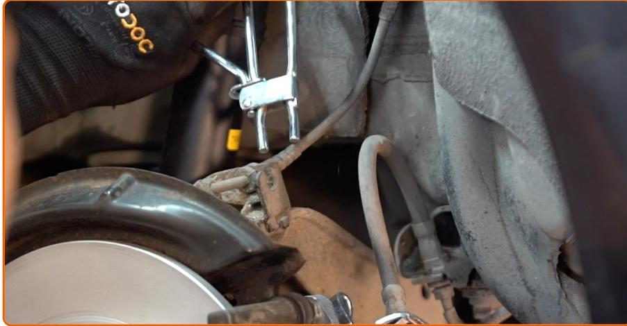
Entfernen Sie die Bremsschlauchklemmen.
