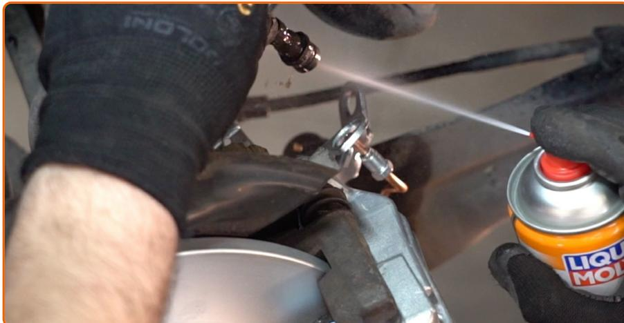
Behandeln Sie den Bremsschlauch. Benutzen Sie einen Bremsenreiniger.
