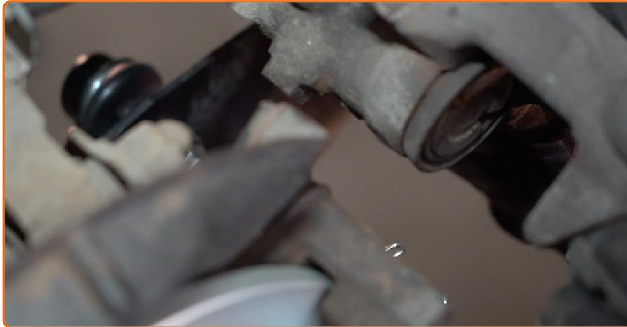
Entfernen Sie den Bremssattel.
