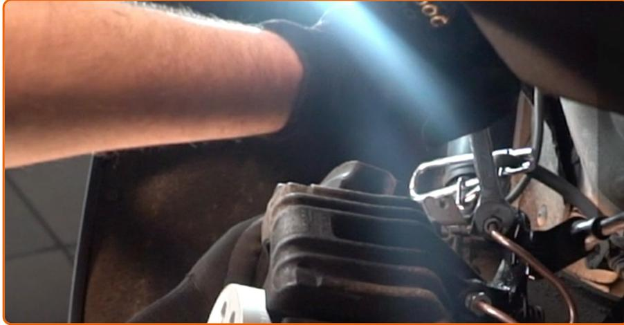
Schrauben Sie den Bremsschlauch vom Bremssattel ab. Verwenden Sie Ring-Gabelschlüssel Nr. 11.
