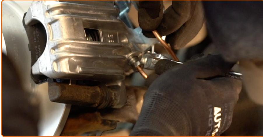
Drehen Sie das Befestigungselement ein, das die Bremsleitung mit dem Bremssattel verbindet. Verwenden Sie Ring-Gabelschlüssel Nr. 13.
