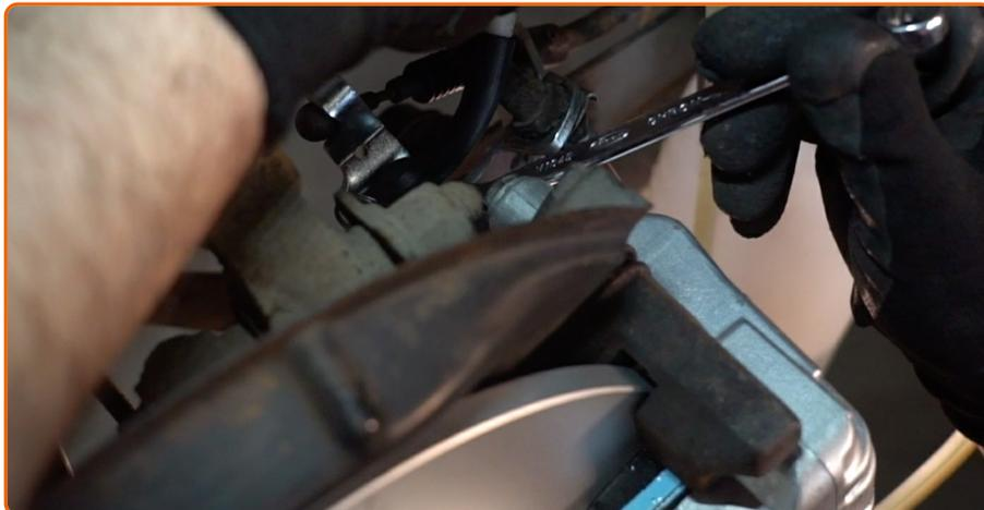
Ziehen Sie die Bremsentlüftungsschraube an. Verwenden Sie Ring-Gabelschlüssel Nr. 11.
