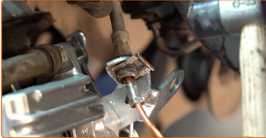
Bringen Sie die Halteklammer des Bremsschlauchs an. Verwenden Sie einen Gummi-Hammer.
