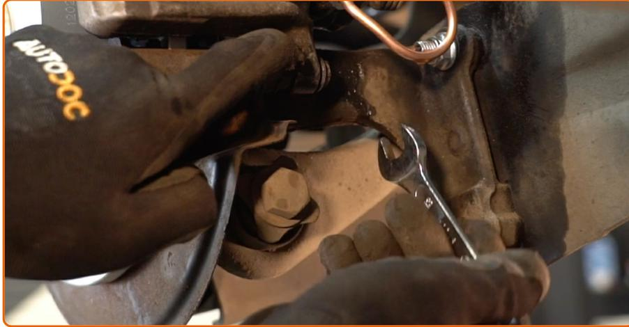
Drehen Sie das Befestigungselement auf, das die Bremsleitung mit dem Bremsschlauch verbindet. Verwenden Sie Ring-Gabelschlüssel Nr. 13.
