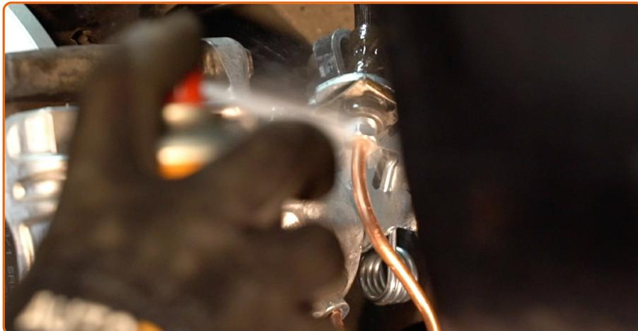
Die Bremssattelbefestigungen reinigen. Benutzen Sie einen Bremsenreiniger.
