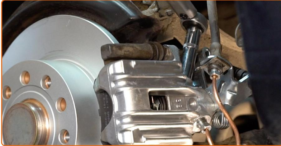
Ziehen Sie die Entlüftungsschraube des Bremssattels an. Verwenden Sie Stecknuss Nr. 11. Verwenden Sie einen Drehmomentschlüssel. Ziehen Sie ihn mit 25 Nm Drehmoment fest.
