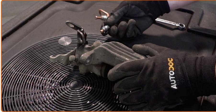
Drehen Sie das Befestigungselement auf, das die Bremsleitung mit dem Bremssattel verbindet. Verwenden Sie Ring-Gabelschlüssel Nr. 13.
