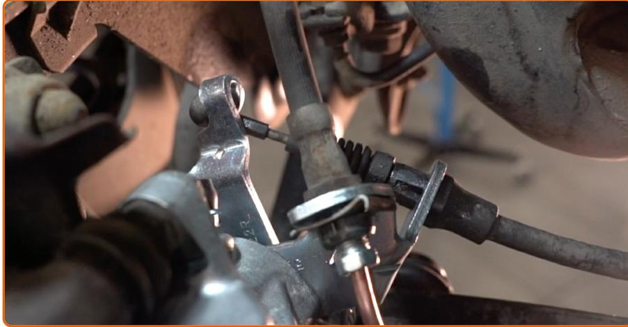
Sichern Sie das Feststellbremskabel mit der Halteklammer.
