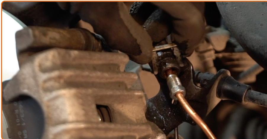
Behandeln Sie die Halteklammer des Bremsschlauchs. Benutzen Sie ein Brecheisen.
