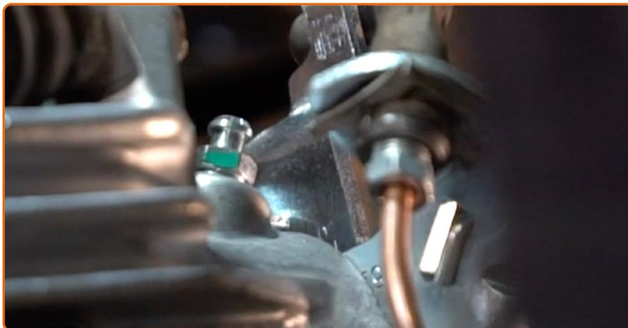
Lösen Sie die Kappe für die Entlüftungsschraube des Bremssattels. Benutzen Sie ein Brecheisen.
