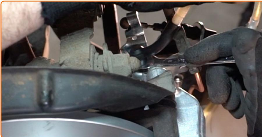
Lösen Sie die Bremsentlüftungsschraube. Verwenden Sie Ring-Gabelschlüssel Nr. 11.
