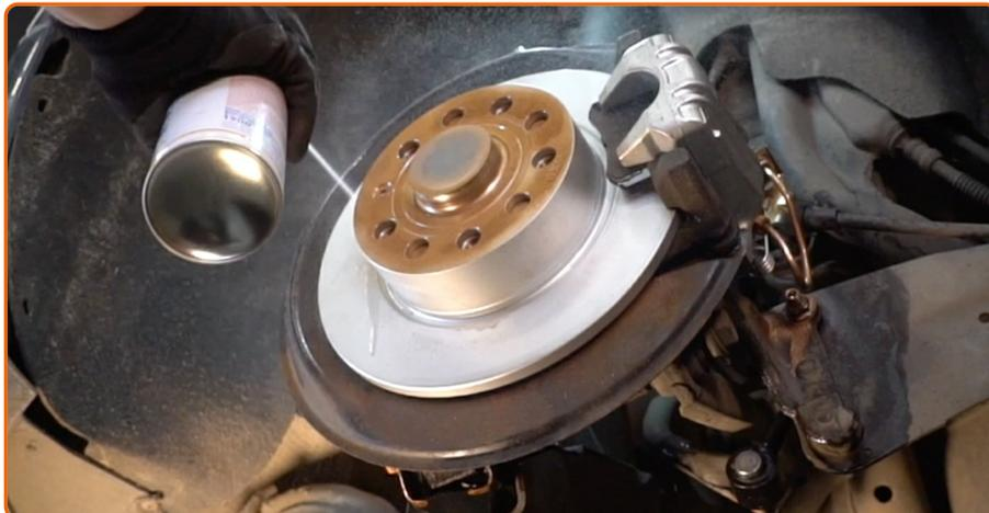
Die Bremsscheibenoberfläche reinigen. Benutzen Sie einen Bremsenreiniger.
