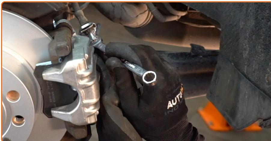
Drehen Sie das Befestigungselement ein, das die Bremsleitung mit dem Bremsschlauch verbindet. Verwenden Sie Ring-Gabelschlüssel Nr. 13.
