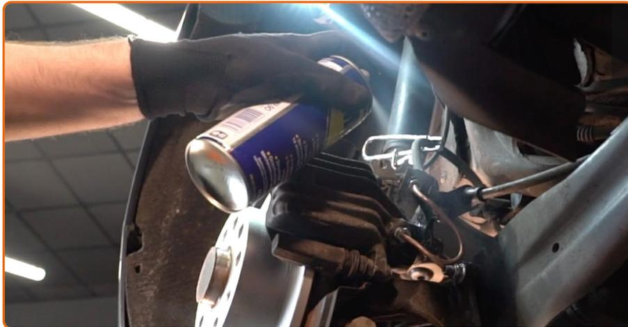
Reinigen Sie den Bereich, in welchem der Bremsschlauch an den Bremssattel angeschlossen ist, sowie den Bereich der Führungsbolzen. Benutzen Sie eine Drahtbürste. Benutzen Sie einen Bremsenreiniger.
