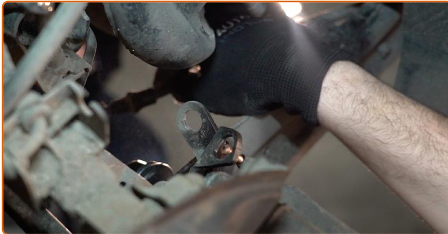
Entfernen Sie das Handbremsseil.
