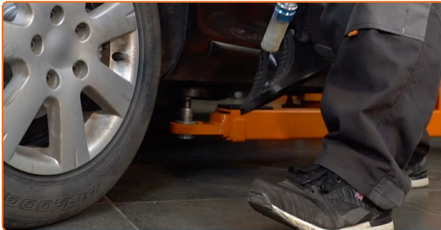
Entfernen Sie den Wagenheber sowie die Unterlegkeile.
