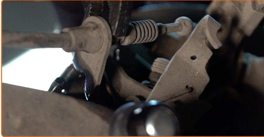
Entfernen Sie den Halteklammer des Parkbremskabels. Benutzen Sie ein Brecheisen.
