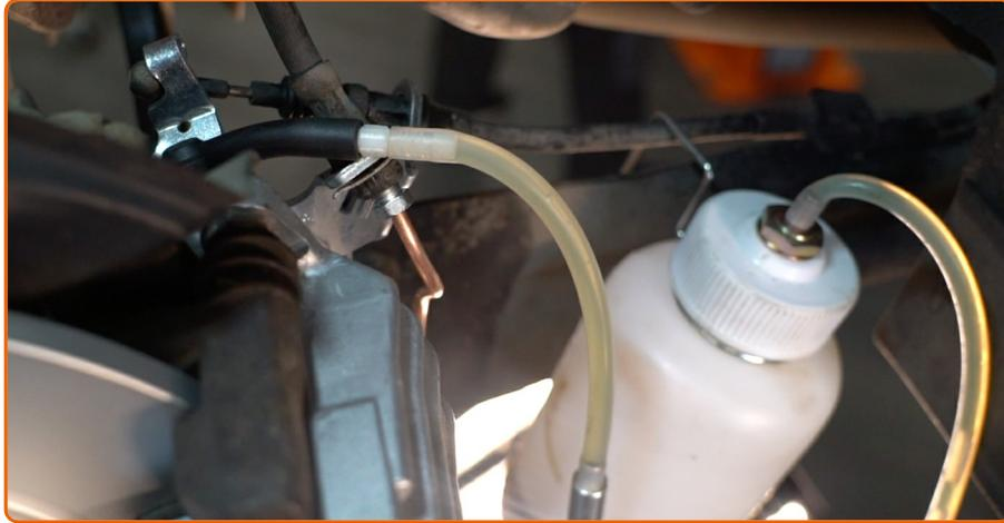
Entlüften Sie das Bremssattelsystem. Ohne das Starten des Motors drücken Sie das Bremspedal mehrmals, bis Sie signifikanten Widerstand spüren.
